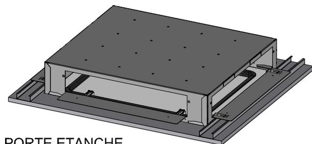
PORTE ETANCHE S'ADAPTE SUR UN ZB05, EN CLOISON OU AU PLAFOND.
